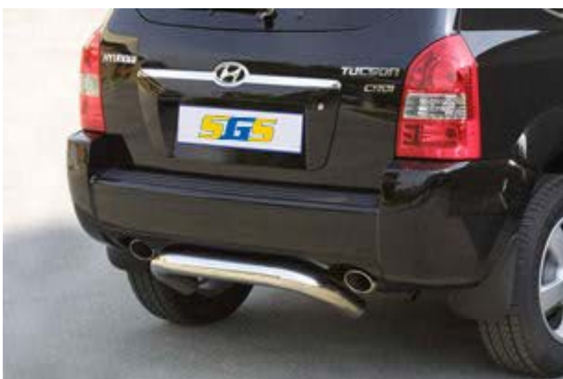
PP1/152/IX * Heckstoßstange Ø 76mm, Edelstahl
