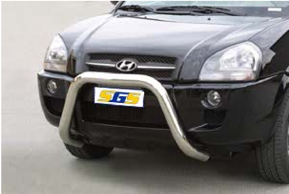
EC/SB/152/IX EU-Personenschutz Bügel, Ø 76mm, Edelstahl
