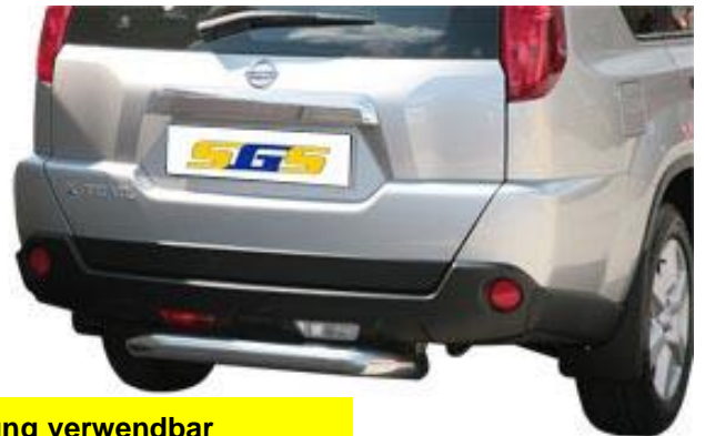
PP1/207/IX ** T31 Bj. 2007- PPA/145/IX ** T30 Bj. 2004- Heckstoßstange Ø 76mm, Edelstahl
