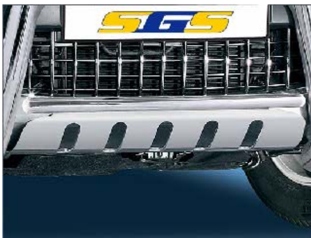
12D4141 EU-Querrohr inkl. Unterfahrschutzblech Ø 35mm, Edelstahl nur gültig mit 42D4413 oder 42D4713
